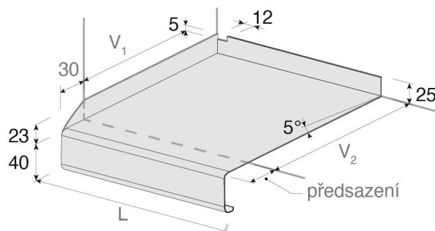
13. Rozměry parapetního plechu se **spádem 5°** musí odpovídat parametrům na obrázku. V rozích zadního lemu plechu je nutné vytvořit zářezy 12 x 5 mm pro zasunutí plechu.
